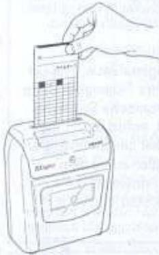
Führen Sie eine Zeitkarte leicht in den Kartenschlitz ein. Die Karte wird danach automatisch hineingezogen und bedruckt.
