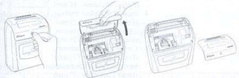
1. Stecken Sie den Schlüssel in das Schlüsselloch und drehen Sie diesen im Uhrzeigersinn.
