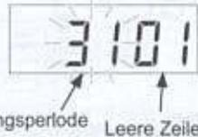
**3** Drücken Sie die "+"- oder "-"-Taste, um das Enddatum der Abrechnungsperiode zu ändern, und stellen Sie es auf den 25. anstelle des 31. ein. Drücken Sie die "E"-Taste, um diese Einstellung zu registrieren.
