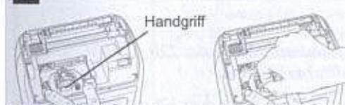
Während Sie an den Farbbandhaltern nach vorne ziehen, ziehen Sie den Handgriff der Farbbandkassette heraus, um die Kassette zu entfernen.
