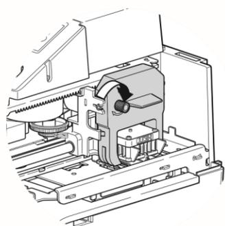
**5** Drehknopf der Farbbandkassette in Pfeilrichtung drehen, bis das Farbband gespannt ist.
