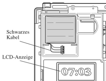
**1** Mit dem Schlüssel entriegeln und die Abdeckung abnehmen.
