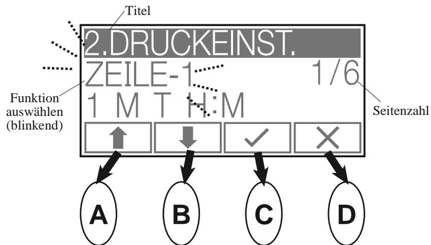
Die Funktionen der Bedientasten (A-B-C-D) werden durch die Symbole am LCD angezeigt. Zur Ausführung einer blinkenden Funktion einfach die entsprechende Taste drücken.
