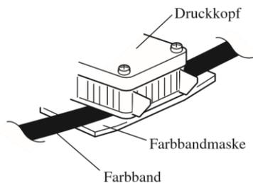
beiden Seiten einrastet. Durch Drehen des Transportknopfes für das Farbband an der Kassette lässt sich diese leichter einbauen.
